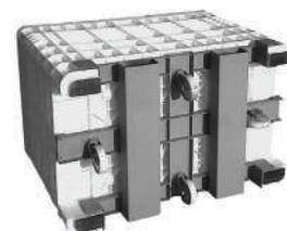
Note: ruote in nylon bianco o gomma piena saldate su telaio di rinforzo in ferro verniciato. In alternativa le ruote possono essere montate direttamente nei piedi senza l'utilizzo del telaio. Barre in ferro verniciato o acciaio inox per l'inserimento delle pale del muletto. Per il ribaltamento è necessario che il muletto sia dotato di castello girevole. Coperchio ad appoggio colore grigio.
